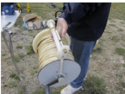
Vista detalle sonda 300 m desmontada.
