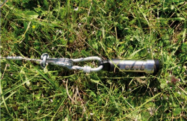
Dispositivo de registro en continuo (Diver) instalado en el aluvial del Ebro en Miranda.
