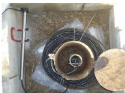
Vista de detalle piezómetro automatizado.
