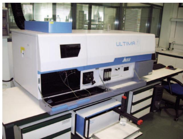
Equipo de plasma acoplado inductivamente (ICP-OES).
