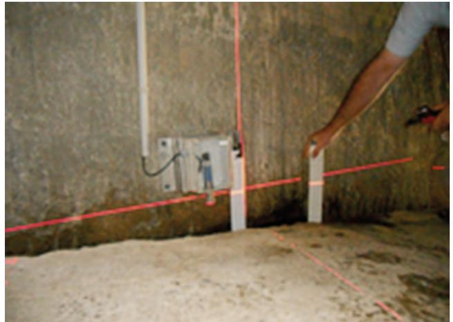
Ajuste de aforador para el cálculo de filtraciones mediante láser, calibrando la escala manual en el vértice del vertedero.
