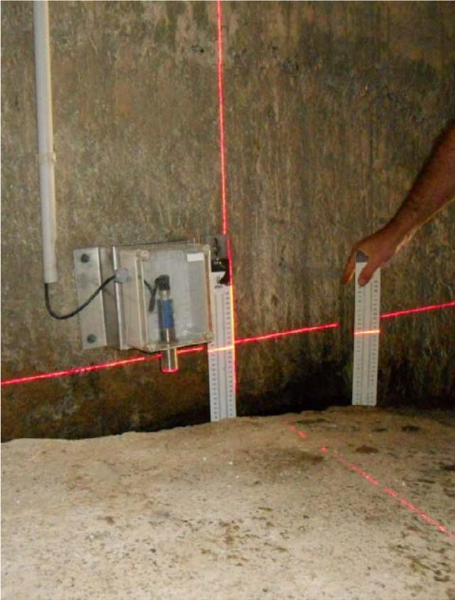
Ajuste de aforador para el cálculo de filtraciones mediante láser, calibrando la escala manual en el vértice del vertedero
