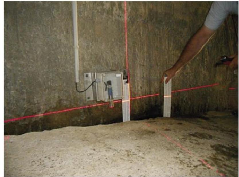
Ajuste de aforador para el cálculo de filtraciones mediante láser, calibrando la escala manual en el vértice del vertedero.
